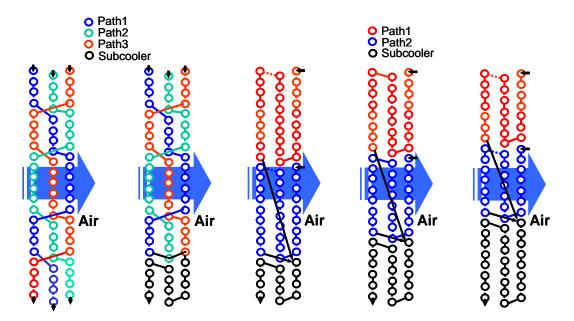
(a) 3:3 w/o sc (b) 3:1 w 12 tubes sc (c) 2:1 w 12 tubes sc (d) 2:1 w 18 tubes sc (e) 2:1 w 24 tubes sc Figure 6: Condenser Circuits
